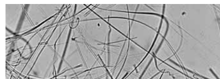
Microfibres de verre peu serrées vues au microscope
