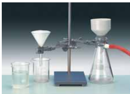
Filtration sous vide avec un disque filtrant dans un entonnoir Büchner (à droite). Avec l'aimable autorisation de Phywe Systeme GmbH
